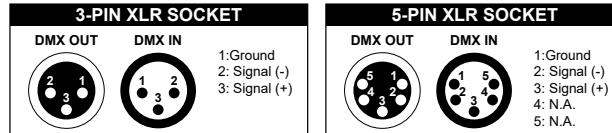
灯具设有标准的 DMX 输入和输出的 3 芯 XLR 插，请使用 DMX512 屏蔽双绞信号线。信号线一般连接距离为 150 米，长距离信号传输时，必须加入 DMX512 信号放大器。
