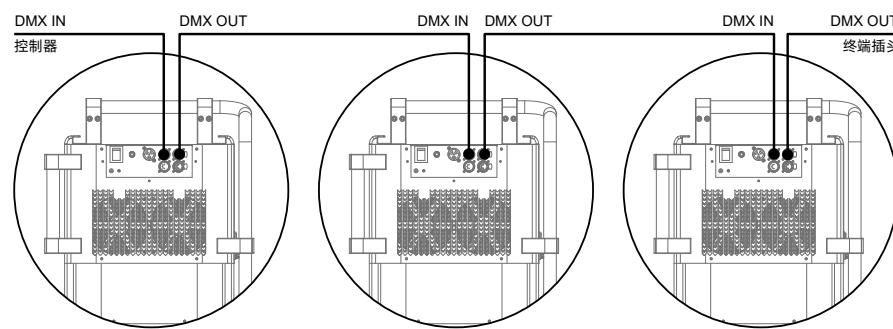
使用一条屏蔽双绞信号线从控制器的 DMX 输出口连接到第一台设备的 DMX 输入口，并从第一台设备的 DMX 输出口连接到第二台设备的 DMX 输入口，依此类推，直到将所有的灯具连接完毕，然后在每一连路的最后一个连接灯具输出 3 芯插孔上安装一个终端插头。（在 3 芯带针卡依插头的 2、3 插针之间焊接一个 4/1W、120Ω 的电阻）。
