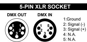
灯具设有标准的 DMX 输入和输出的 3/5 芯 XLR 插，请使用 DMX512 屏蔽双绞信号线。信号线一般连接距离为 150 米，长距离信号传输时，必须加入 DMX512 信号放大器。
