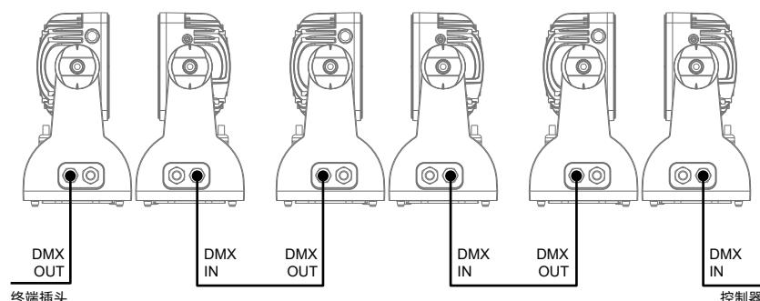
使用一条屏蔽双绞信号线从控制器的 DMX 输出口连接到第一台设备的 DMX 输入口，并从第一台设备的 DMX 输出口连接到第二台设备的 DMX 输入口，依此类推，直到将所有的灯具连接完毕，然后在每一连路的最后一个连接灯具输出 3/5 芯插孔上安装一个终端插头。（在 3/5 芯带针卡依插头的 2、3 插针之间焊接一个 4/1W、120Ω 的电阻）。
